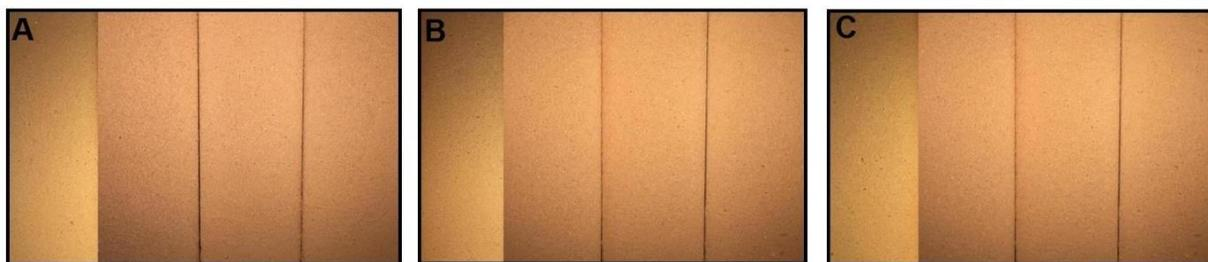
Figura 7. Fotos dos corpos de prova das formulações estudadas na temperatura de 850°C; B) 900°C; e C) 1000°C, com taxa de aquecimento de 10°C/min, no tempo de 1 hora.
